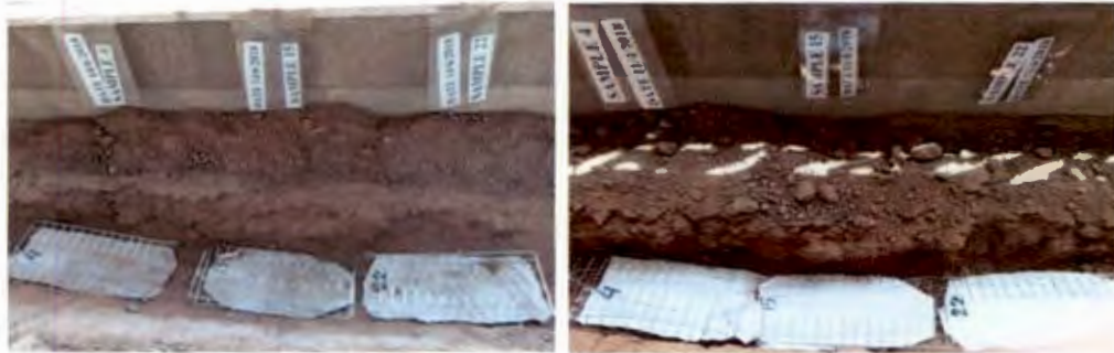
شكل (٦) يمين) عينات إحرام البولي أستر (٢٢ و ١٥ و ٤) أثناء وضعها داخل التربة بتاريخ ٢٠١٨/٤/١١ . شكل (٧) يسار) عينات إحرام البولي أستر بعد شهرين بتاريخ ٢٠١٨/٦/١٤ .
